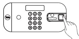
③确认登记指纹，液晶屏显示“AGAIN”，再次把同一个手指放在指纹窗上不动。如果登记成功，系统提示“嘟嘟”2声，液晶屏显示“dONE”，系统退回待机状态。如果登记失败，则液晶屏显示“E-CODE”，听到提示“嘟~~”长音，退回待机状态。
