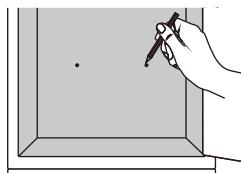
2.移开保险箱，在墙壁记号位置用12毫米钻头钻两个安装孔(钻孔深度以配件螺钉长度为宜)
