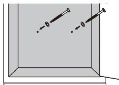
3.将保险箱安装孔与墙上钻孔位置对齐，用附件螺丝钉由柜内向外插入墙上钻孔
